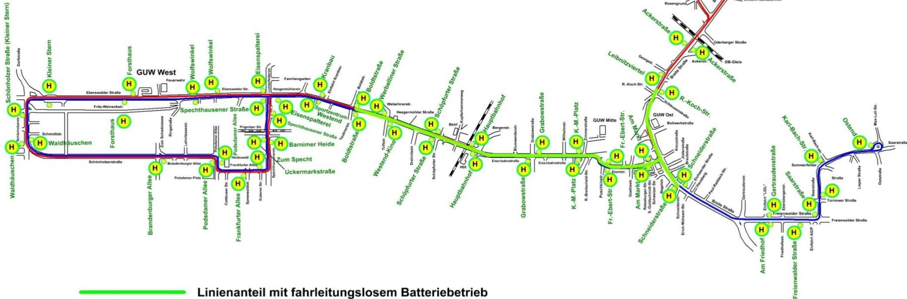
Linienanteil mit fahrleitungslosem Batteriebetrieb
